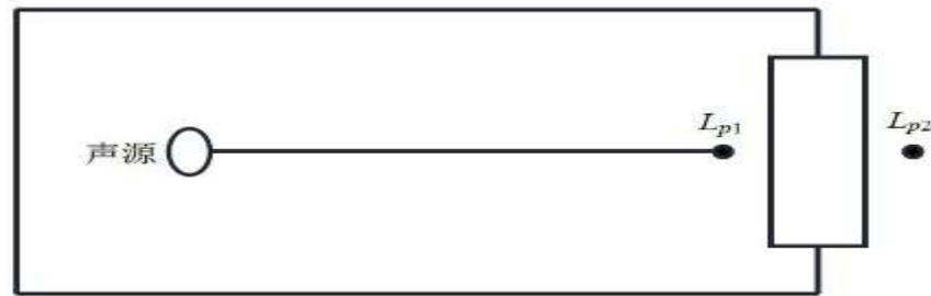
图 4-3 室内声源等效为室外声源图例
